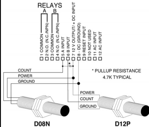
**Flow Meter Wiring Diagram**
